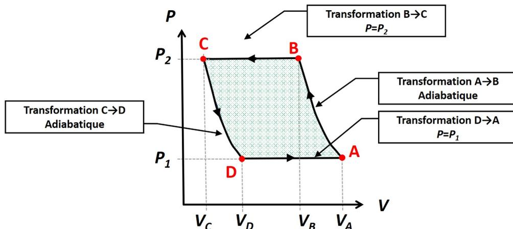
FIGURE 2 – Cycle thermodynamique d'une pompe à chaleur.
