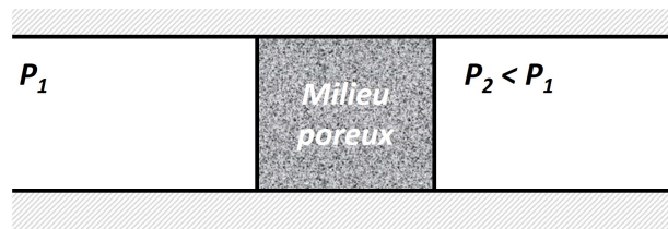
FIGURE 7 – Détente de Joule-Thomson.
