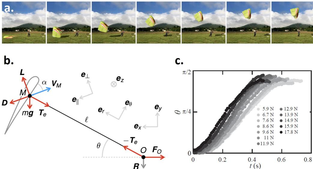
FIGURE 5 – a. Photos d'un gonflement d'aile de parapente. Les photos sont prises à intervalles réguliers de gauche à droite. b. Modélisation d'une voile de parapente. c. Trajectoire de l'aile de parapente pour plusieurs valeurs de la force motrice  $F_0$ . Ici  $X = x/l$  et  $Y = y/l$ . Sources : Lopes et al., *American Journal of Physics* **91** 340 2023.
