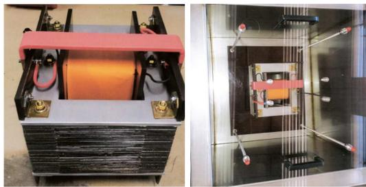
FIGURE 2 – vue de détail de l'inductance, vue d'ensemble dans la cuve à huile
